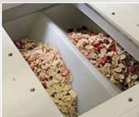
Зона загрузки с силиконовыми уплотнителями
