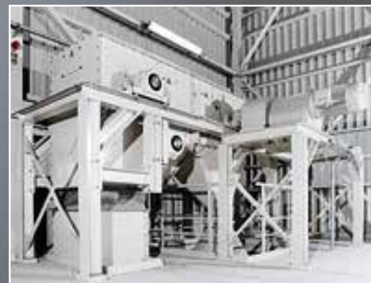
Станция выгрузки элеватора WB 640 с приводом 30 кВт
